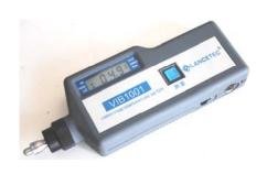
VIB1001按加速度传感器接入模式分为一体式或分体式两种模式。仪器功耗低, 采用9V叠层电池即可连续使用大于24小时的时间。
